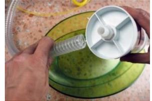
**4 \_** La imagen en el lateral muestra el separador de amalgama usado y desconectado de las líneas de aspiración. Los tapones de vinilo negro están colocados firmemente en ambos extremos y el filtro está listo para su eliminación. Ahora se puede instalar un nuevo separador de amalgama DDS2011 conectando los tubos de aspiración a los conectores apropiados.
