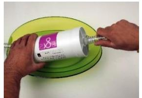
La tubería de la línea de succión debe mantenerse dentro de la cubeta para recoger cualquier posible fuga de líquidos. Cualquier agua residual que se acumule en el recipiente debe eliminarse adecuadamente.
