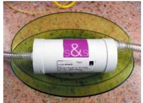
**3 \_** Incline el lado de entrada del separador hacia arriba unos 45° y retire el tubo de aspiración del accesorio que lo conecta al puerto de entrada del separador.
