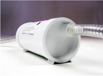
La imagen de la izquierda muestra la boquilla de entrada del separador DDS2011. Observe cómo la puerta delantera está "fuera de eje". La tapa de vinilo negro que tapa el conector debe retirarse para su instalación, pero debe conservarse. Cuando se debe reemplazar el separador, se debe reemplazar la tapa negra en el conector para evitar cualquier fuga de material o residuos.
