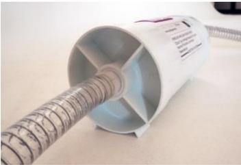
La imagen de la izquierda muestra el lado de salida del separador DDS2011. Observe cómo la puerta de salida está en línea con el eje central del separador. Este lado del separador está conectado al motor de aspiración. Los tapones de vinilo de los conectores deben ser retenidos. Cuando se debe reemplazar el separador, las tapas deben reemplazarse en los conectores para evitar fugas de material o residuos.
