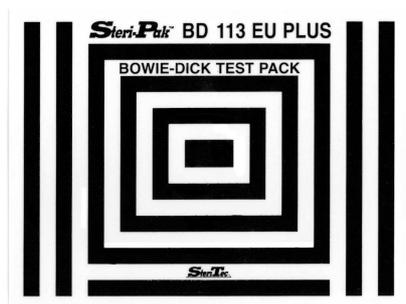
La evaluación del resultado es sencilla y rápida. Si el aspecto es uniforme (tal y como se indica en la imagen) significa que el test es positivo, en caso contrario el autoclave no puede esterilizar correctamente los cuerpos porosos.
